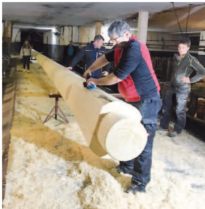
Die Alteiselfinger beim Hobeln des Griesstätter Maibaums; die Anpassung an den Baumständer und die Anpassung der Maibaumspitze sowie der Tafeln wird durch die Ortsvereine erledigt.
